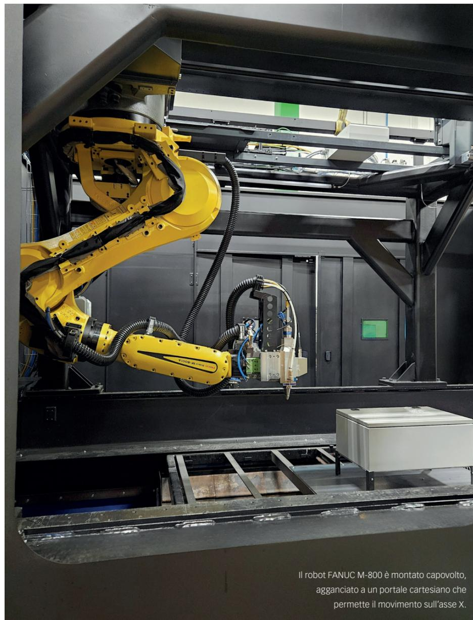
Il robot FANUC M-800 è montato capovolto, agganciato a un portale cartesiano che permette il movimento sull'asse X.
