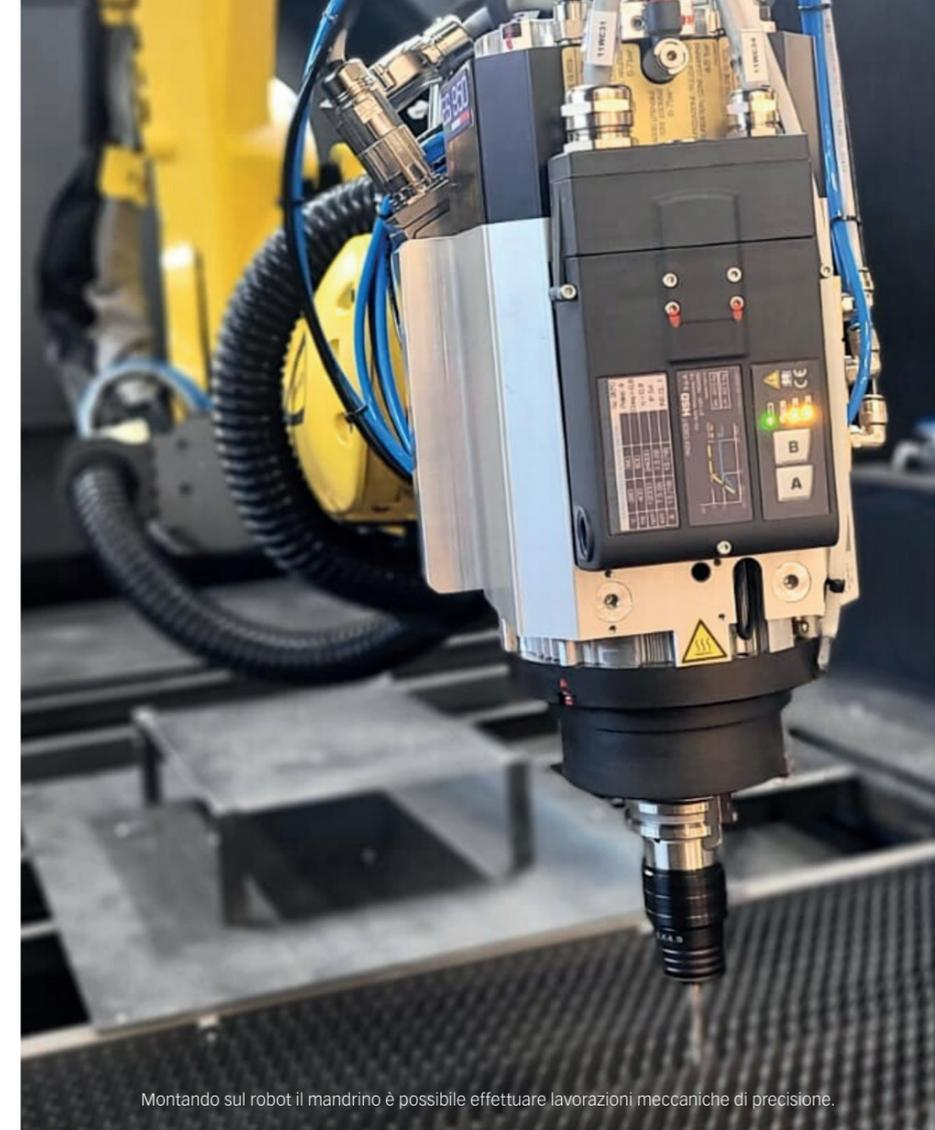
Montando sul robot il mandrino è possibile effettuare lavorazioni meccaniche di precisione.
